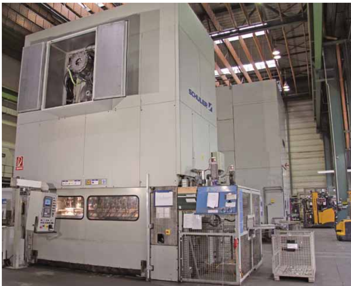
Bild 1: Beim Umbau mit Schwungrad angetriebener Pressen wird ein Servomotor auf die Antriebswelle platziert, der alte Motor bleibt erhalten.
