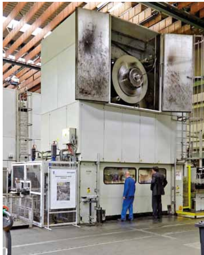
Bild 2: Die Exzenterpresse ist mit einem Schwungrad ausgestattet, das vom Hauptmotor angetrieben wird.
