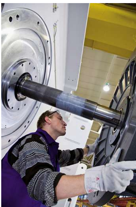
Bild 5: Für die Schuler-Pressen liefert Oswald Torquemotoren mit einer Leistungsbandbreite von 61 bis 460 kW.
