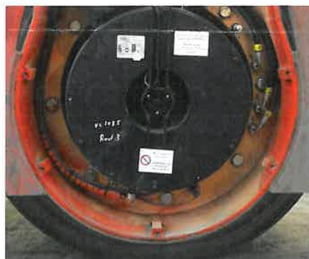
Flüssigkeitsgekühlter Radnabenantrieb in robuster Asynchroneausführung
