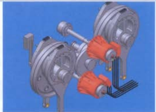
Das Kopfstück der mit 11.000 kN Presskraft größten Servopresse der Welt mit den beiden 500 kW Servomotoren (rot).
