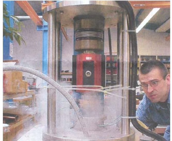
Elektromechaniker Franz Walter bei der Demonstration eines Stickstoff gekühlten HTS-Motors
