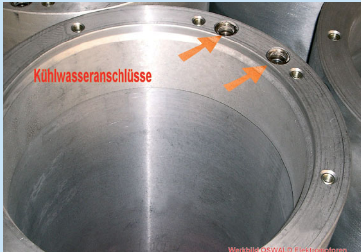
Das Motorgehäuse ist für Wasserkühlung vorbereitet
